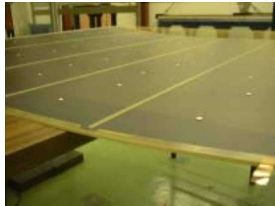
Fig. 3.15: ワイヤーの張力でたわんだグランド板
