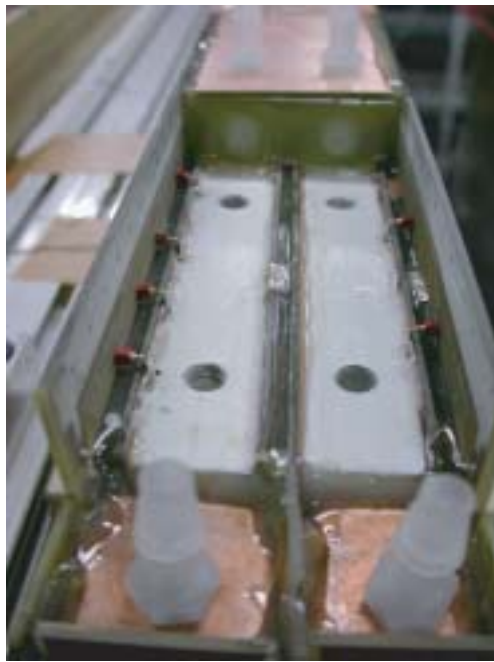
Fig. 5.24: 20mm FRP フレームと Chamber の隙間と 4 つのネジ穴 (前後にあるのは CO_2 Channel 用ガス口)
