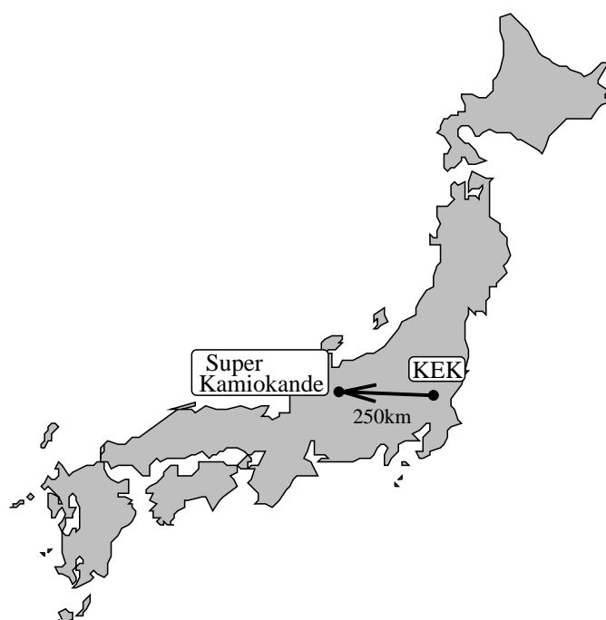
図 2.1: つくば－神岡間長基線ニュートリノ振動実験 (K2K 実験)。茨城県つくば市の高エネルギー加速器研究機構から約 250km 離れた岐阜県吉城郡神岡町のスーパーカミオカンデに向けてニュートリノビームを発射する。
