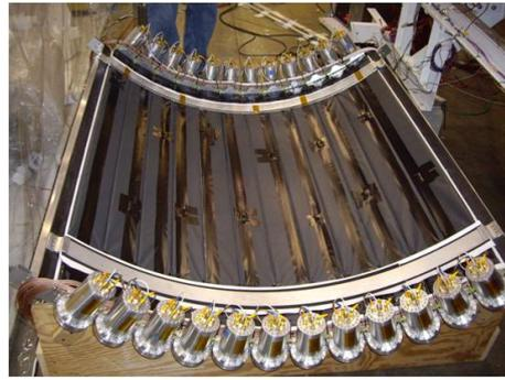
図 2.7: 検出器最上部に設置されている TOF カウンター (UTOF)      図 2.8: 検出器最下層に設置されている TOF カウンター (LTOF)
