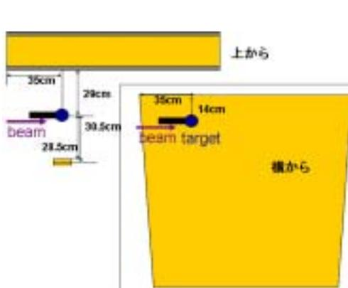
Fig. 5.5: 14MeV TGC 設置位置 (加速劣化試験)
