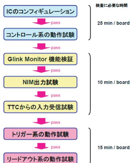
図 5.12: 量産ボード検査の流れ
