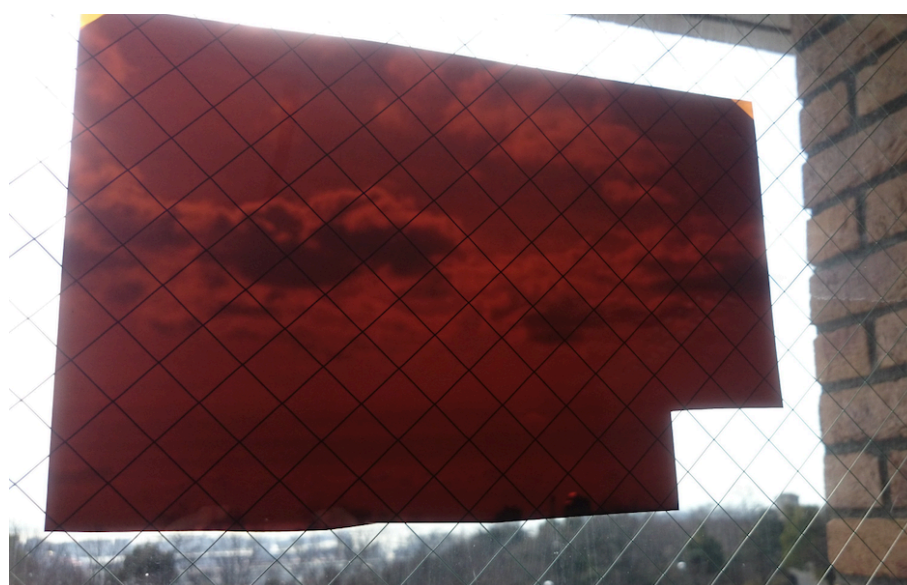
図 2.10 両面に炭素スパッタ薄膜を形成したポリイミドフィルム
