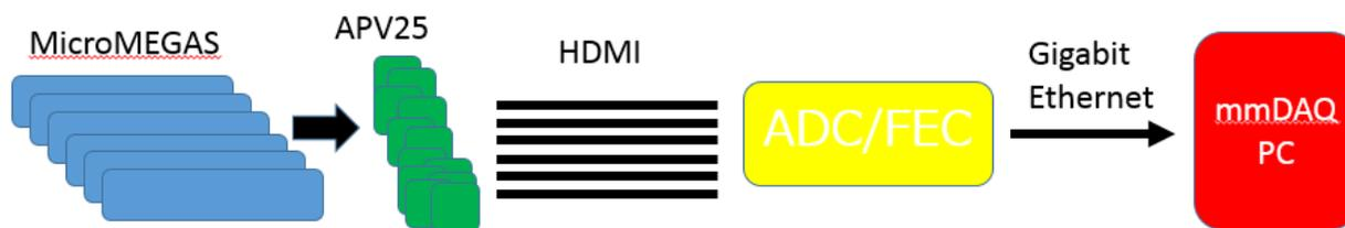
Fig5.11 SRS でのデータフローの図
