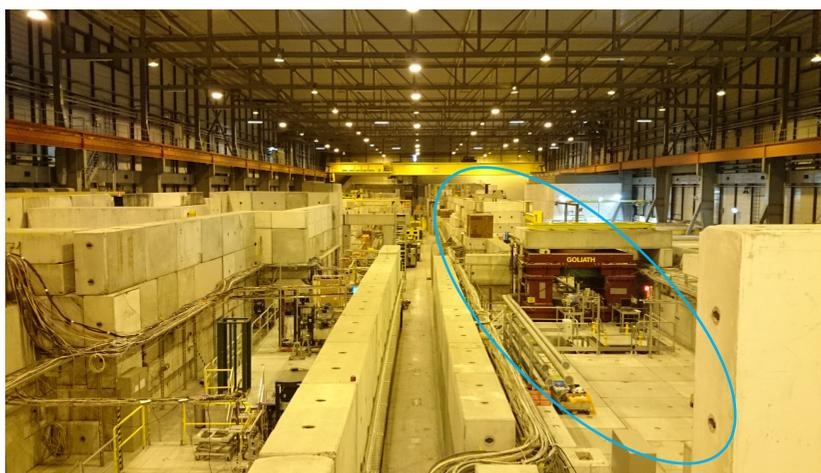
Fig6.1 SPS/Noarth area の EHN1 の写真。水色枠内が H4 ビームラインである。
