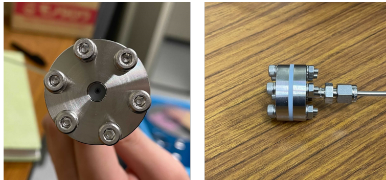
図 5.7 製作したレーザーヘッドの写真。ファイバー口と純水は石英窓で隔てられる。
