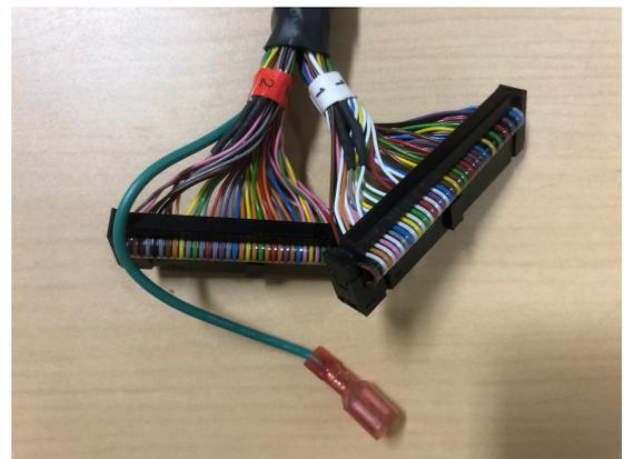
図 5.5: ATLAS 実験で実際に使用されたシグナルケーブルの写真。左図はケーブルの内部構造、右図は信号線の読み出し口。読み出しはケーブルの内側と外側でそれぞれまとめられて行われる。
