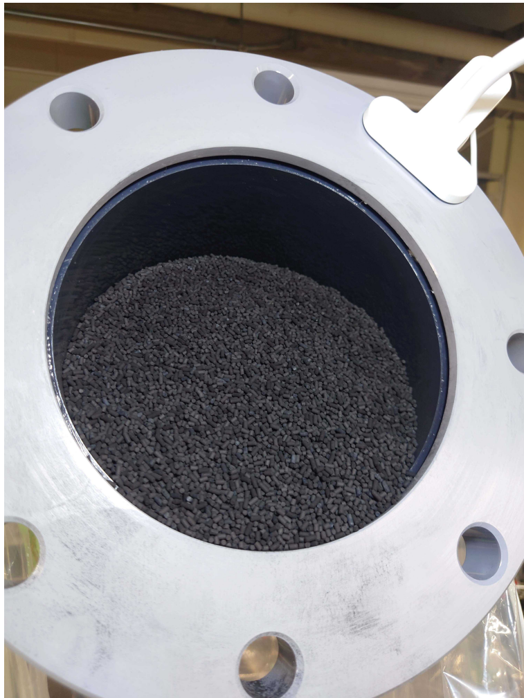
図 2.6: 斜めで詰め込んだ時の PVC カラム 6 の入口の状態
