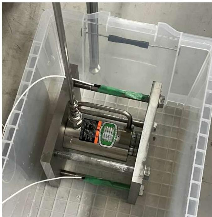
図 3.37: 測温抵抗体の設置場所 (ボルト上部・下部)
