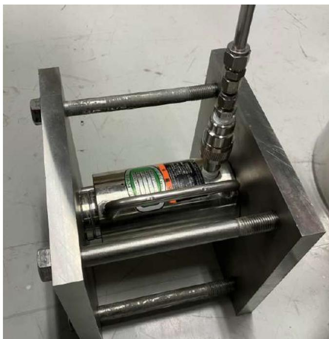
図 3.16: ジャッキと SUS プレートの組み合わせ
