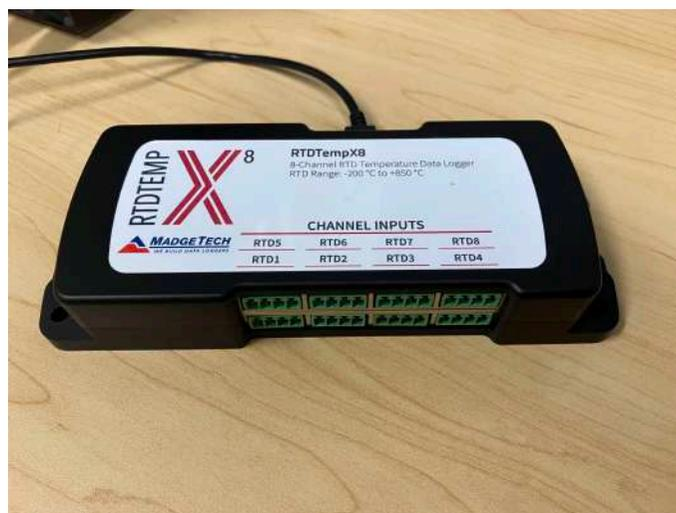
図 3.15: 8 チャンネル温度測定器
