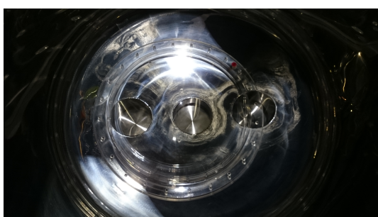
図 4.6.20: 700 L 容器にアクリルカバーを設置した様子
