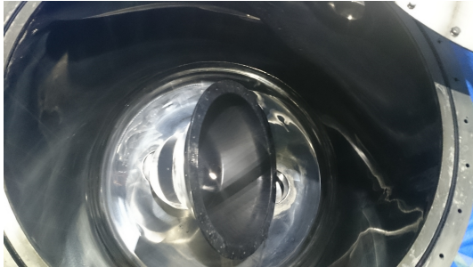
図 4.6.18: 700 L 容器に樹脂カバーを設置した様子
