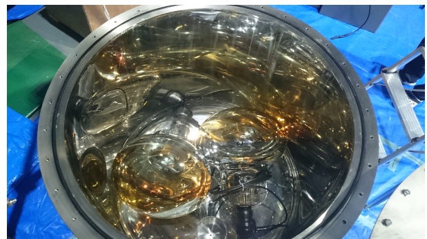
図 4.6.8: 700 L 容器にスーパーカミオカンデ用 PMT を 2 つ設置した様子
