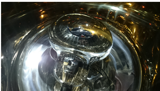
図 4.6.7: 700 L 容器にスーパーカミオカンデ用 PMT を 1 つ設置した様子
