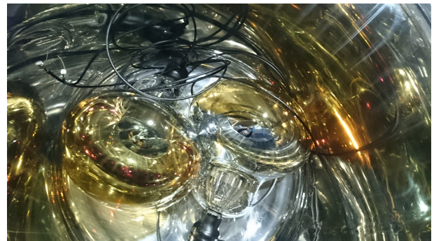
図 4.6.3: 700 L 容器にハイパーカミオカンデ用 PMT を 2 つ設置した様子
