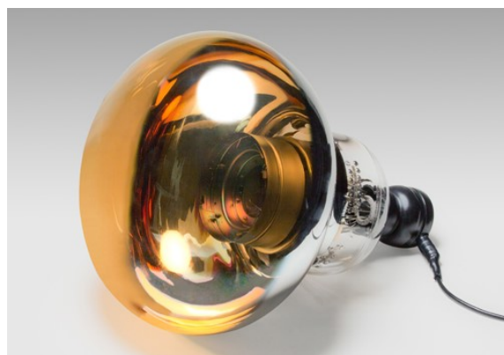
図 4.5.2: スーパーカミオカンデ用 20 インチ PMT の全体写真 [89]
