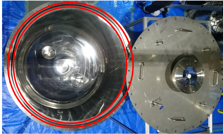
図 4.4.4: 700L 容器を開けた時の写真。赤色の 2 重円で縁取られた黒いリングが O リングである。底面に 3 箇所フランジがある (図 4.3.6) が、ここにも同様のバイトン製 O リングが使用されている。
