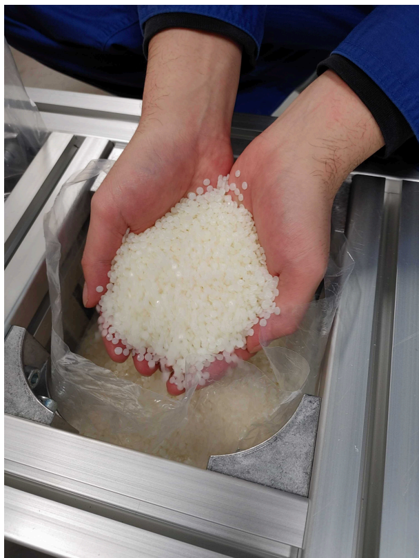
図 53: ポリエチレンペレットの写真。厚さ 1.5 mm、直径 4 mm 程度の粒状になっている。
