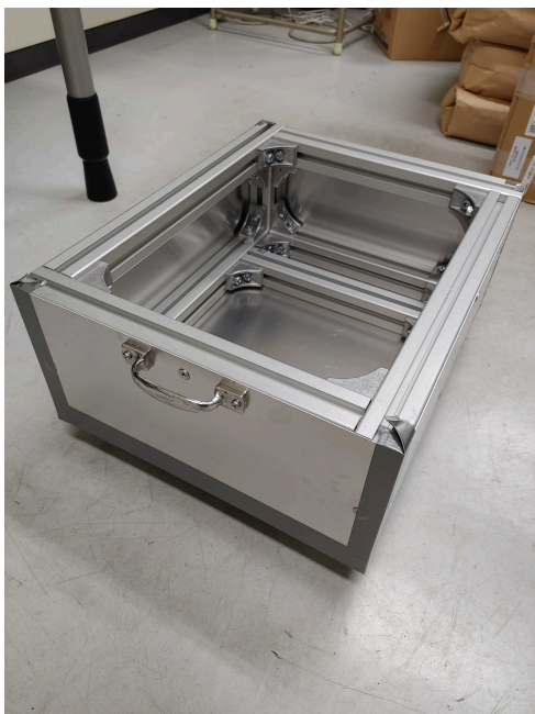
図 57: シールド骨組み
