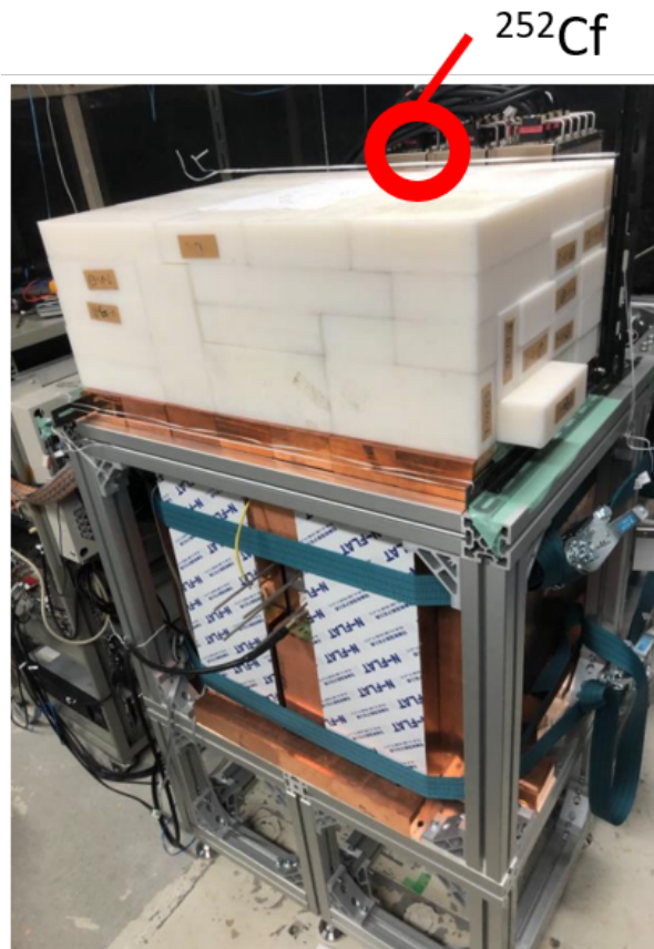
図 51: シールドを設置した状態での測定時の写真。赤い円で囲った部分に ^{252}\text{Cf} 線源を配置し、25 cm のポリエチレンブロックと 5 cm の銅シールドを配置して照射した。
