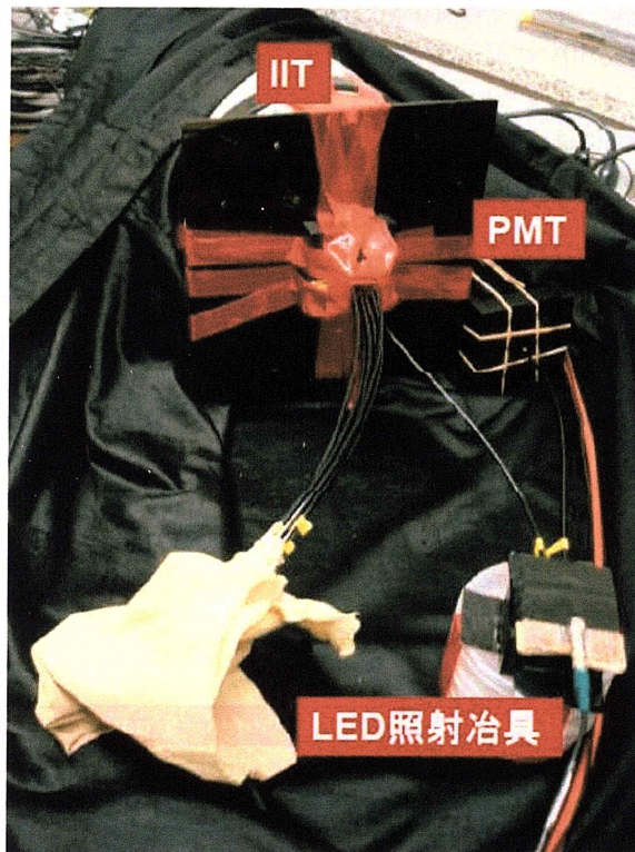
図 5.10: IIT の線形性実験セットアップ
