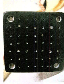
図 3.14: ファイバー治具 (光電面と接地する面)
