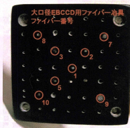
図 4.37: 大口径 EBCCD の線形性実験フローチャート 図 4.38: ファイバー番号と位置関係（大口径 EBCCD 用）
