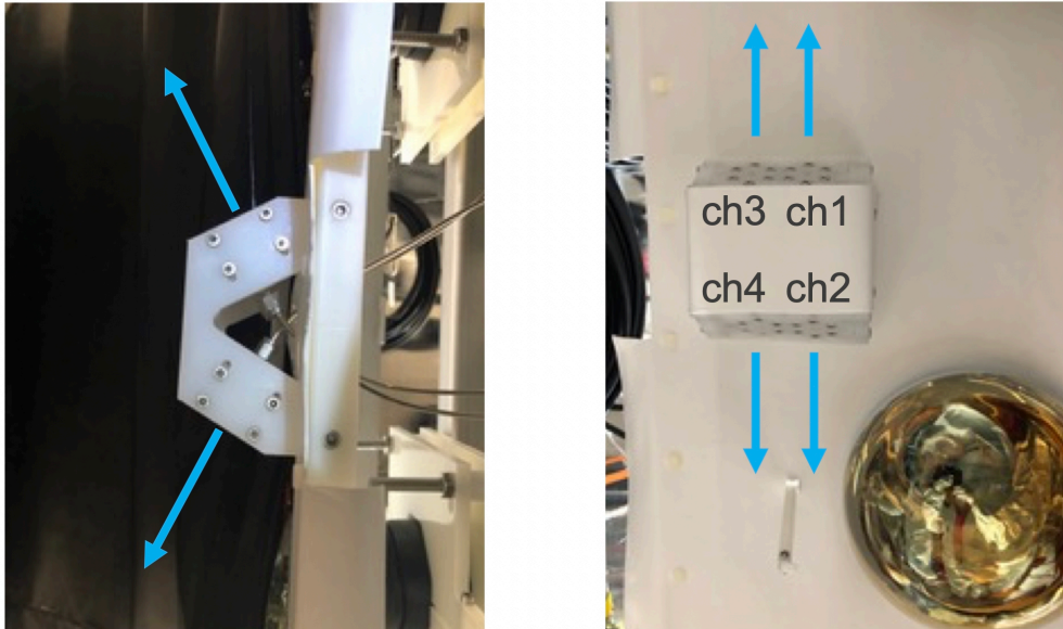
図 4.7 (左) レーザー照射装置の側面図。(右) レーザー照射装置の正面図。中央に位置するポリエチレン製の治具に、上向き 2 つ、下向き 2 つの合計 4 つのレーザーヘッドが固定されている。4 つのレーザーヘッドは右上から順番に、チャンネル 1 (ch1) からチャンネル 4 (ch4) まで名付けられている。ここから矢印のようにレーザーが照射される。
