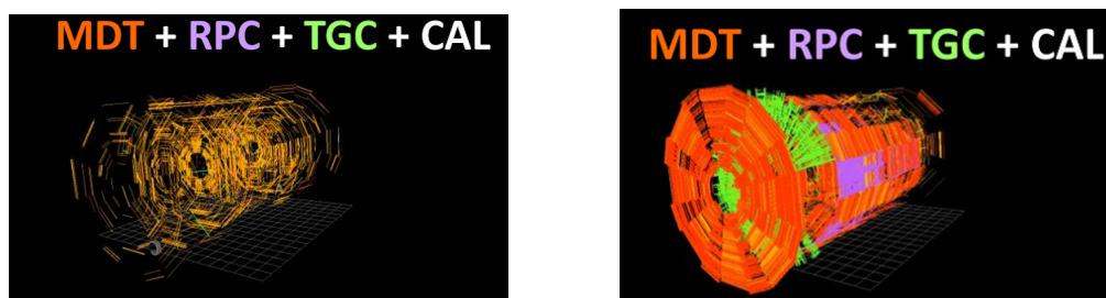
Fig. 3.36: イベントディスプレイの比較 (左) 通常のイベントの例 (右) ノイズによるイベントの例
