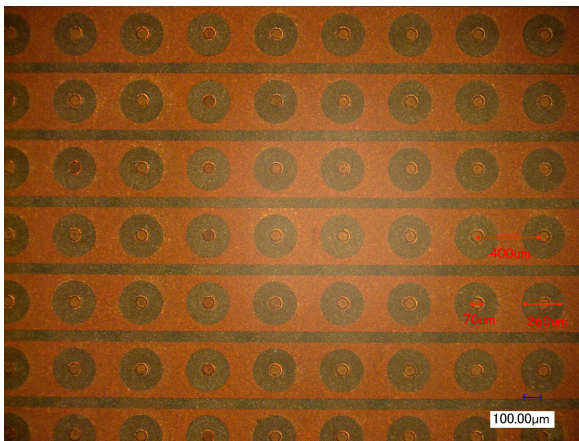
図 7.1: 光学顕微鏡による \mu -PIC の拡大写真。アノードの直径は 70 \mu m、カソードの穴の直径は 260 \mu m である。アノードストリップとカソードストリップは 400 \mu m 間隔で直交するように配置されている。
