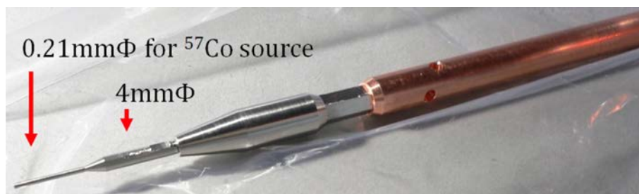
図 3.5: 内部キャリブレーションロッド
