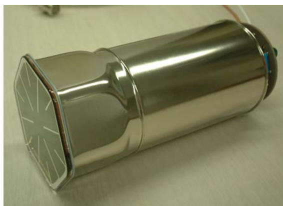
図 3.3: 光電子増倍管 R10789-11
