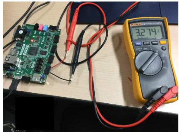
図 5.22: Pmod からの信号。GND と信号出力ピン間の電圧はおよそ 3.3V を示した。
