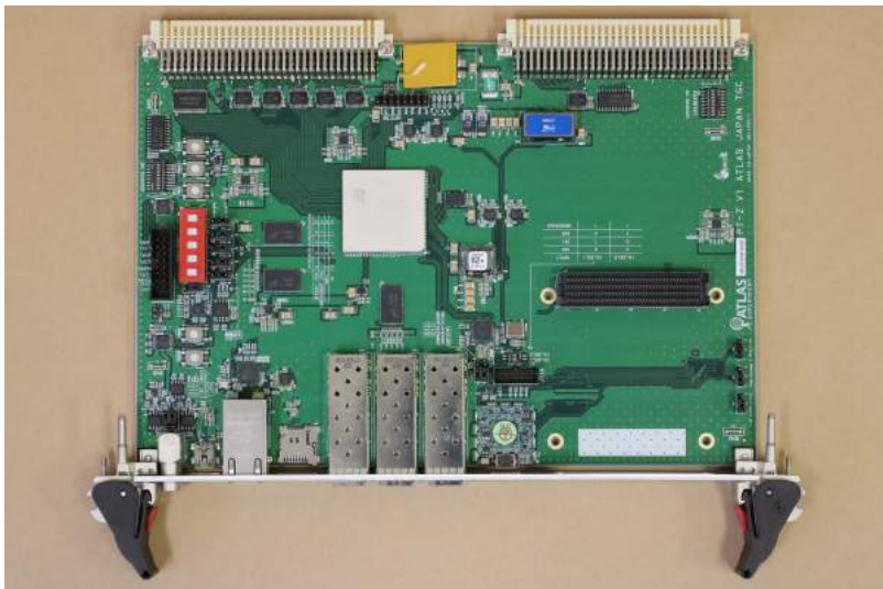
図 6.6: PT-Z 全体図その 2。写真中央左よりに Zynq が設置されている。
