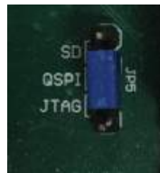
図 5.10: ブートモードを切り替えるジャンパーピン。QSPI、microSD カード、JTAG によるコンフィギュレーションを選択できる。
