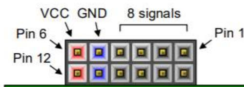
図 5.20: Pmod コネクタ模式図 [?]. 検証では GND と上段のシグナルピン間の電圧を計測した。
