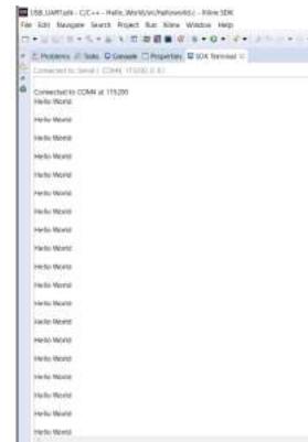
図 5.9: UART アクセスの結果。ターミナルには SDK 付属のものを使用。
