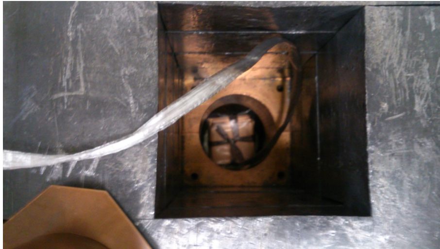
図 5.6 HPGe 検出器の遮蔽の様子。試料を紐で結び中に入れる。
