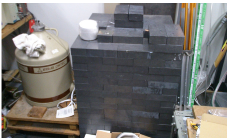
図 5.5 HPGe 検出器の外観。上部の鉛ブロックを外し試料を中に入れる。
