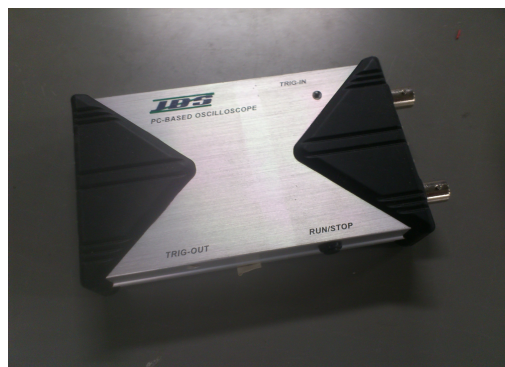
図 5.4: 測定に用いた JDS 製の usb オシロ (uds5202)
