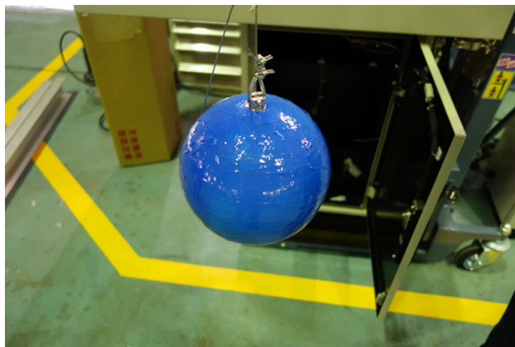
図 3.20 試験に用いた小型ニッケル球。直径 16 cm、重量 3.5 kg。挙動計測装置のため、表面には青いテープが貼り付けてある。
