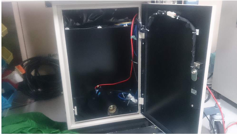
図 3.10 光漏れ確認試験のセットアップ。ソースコンテナ内部に 2 インチ光電子増倍管を設置している。
