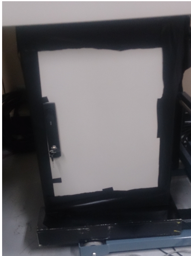
図 3.11 前面ドアの縁を黒シートとビニールテープで遮光している様子。この状態で内部に光電子増倍管を入れて光子数を計測する。
