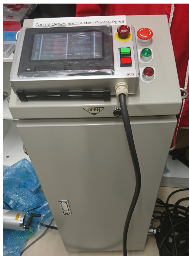
図 3.7 コントロールボックスとディスプレイ。製作当初、ディスプレイはコントロールボックスに埋め込まれており画面も小さかったが、視認性に配慮して画面を大型化、さらに手持ちできるように変更した。
