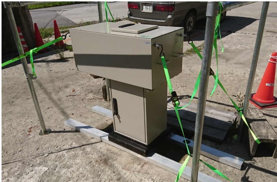
図 3.28 長距離運転試験のセットアップ。C チャンネルと装置の間をクランプで固定し、貨物固定用ベルトで四方を固定している。
