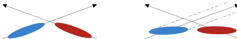
図 2.19: 通常のバンチ衝突 (左) とクラブ衝突 (右) の概念図 [23]。通常のバンチ衝突と比較して、クラブ衝突では衝突時のバンチ同士の重なりが大きくなり、ルミノシティが向上する。
